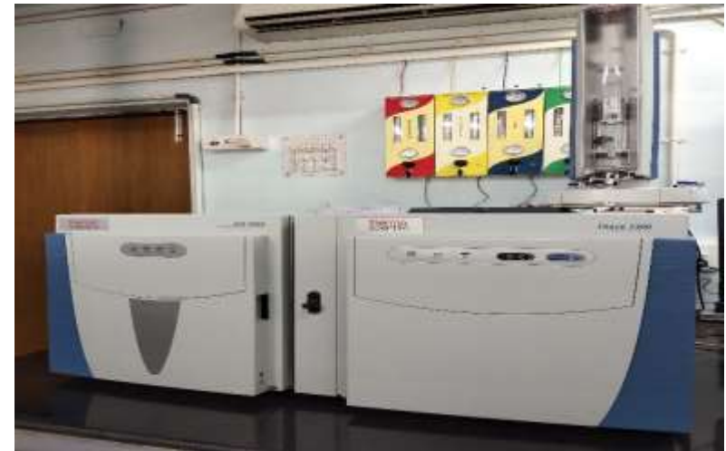
Gas Chromatograph Massen Spektrometer (GCMS) Pestizide und organische Verbindungen
